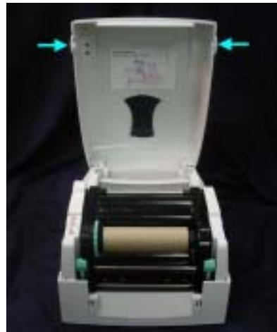
2. ロール軸を取り外し、メモリーカードカバー前の門型キー(図の矢印部分)を押して上向きに引き開けて、メモリーカードカバーを取り外します。
