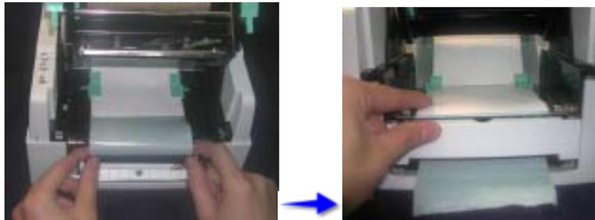
9. プリンタコアを固定した後、FEEDキー押しラベル用紙の位置を決定して、ピラーユニットの取り付けが完成します。
