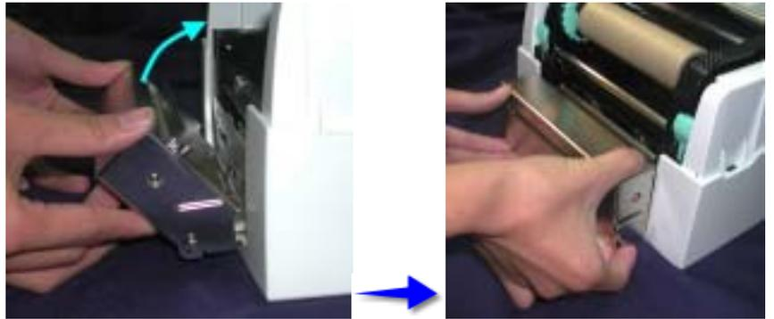
8. プリンタコアを固定してカッターユニットの取り付けが完成します。
