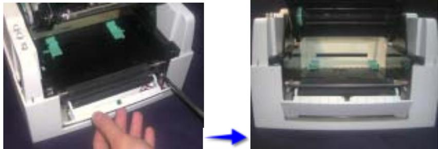
7. ラベル用紙を置いた後、1枚目をはがし、台紙をホイールと用紙切断カッターの間に通します。(P16のピラー取り付け図を参照してください)
