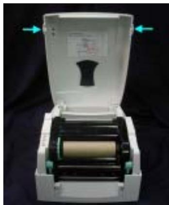
2. 台座覆い板の引っ張り（図の矢印部分）を押し、上から引っ張るように台座覆い板を外します。
