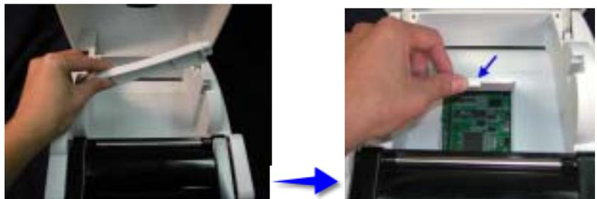
3. PCB製固定ビス(32)をマザーボード上に固定します。
