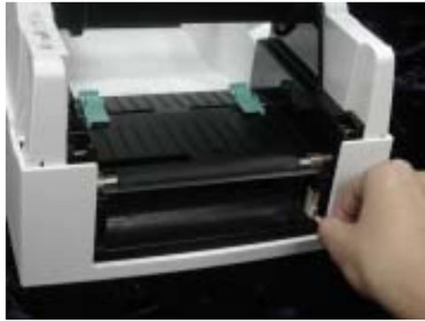
5. ユニットの右側を台座の凹部に取り付けた後、左側をはめ込みます。
