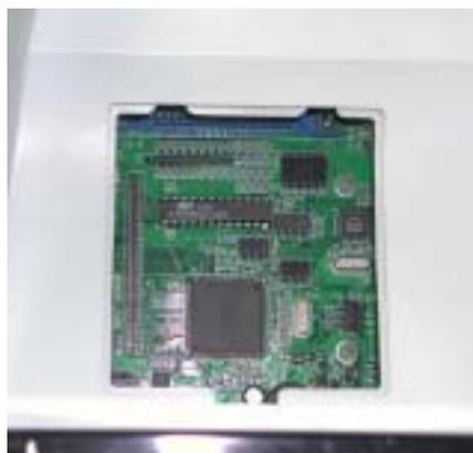
3. 先ずマザーボードとメモリーカードの位置が正しいかどうかを確認し、メモリーカードをマザーボードに取り付けます。
