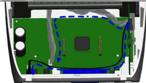
16. アンテナケーブルをアンテナブラケットに通してください。それから図のようにアンテナポートに差し込んでください。
