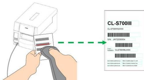
プリンタ本体に接続したバーコードリーダーでスキャンしたデータをラベルに印字します。
