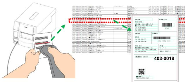
プリンタ本体にダウンロードしたデータベース（CSVファイル）からバーコードリーダーでスキャンしたデータをキーに検索しラベル印字を行います。
